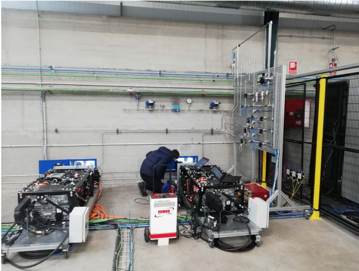
Banco de pruebas de Pilas de Combustible de Toyota en el CNH2
