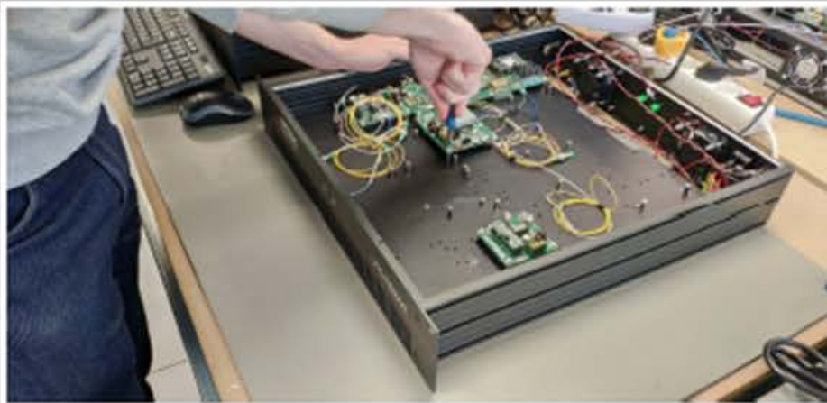
Montaje de Banco de Pruebas y ensayos de los componentes de Fibra Óptica en la solución propuesta para el viaducto de Guadalmazán
