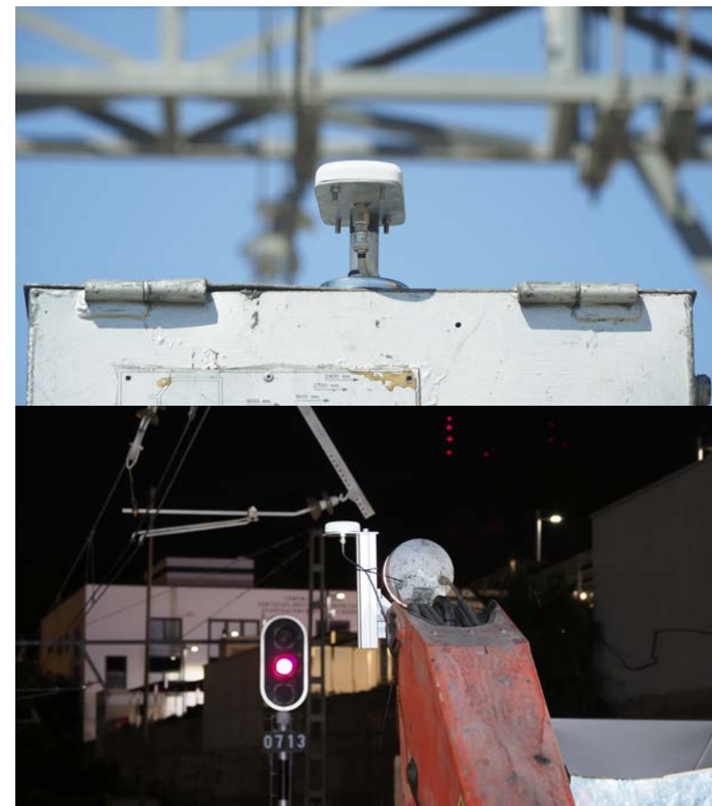
Antenas GNSS instaladas en el exterior para la precampaña de pruebas realizadas en Junio del 2021
