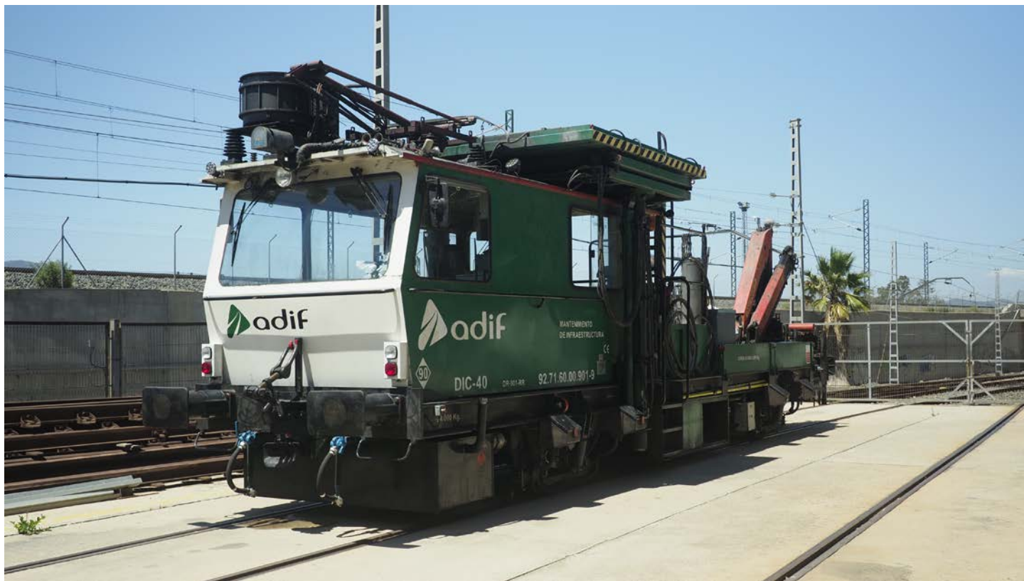
Dresina de electrificación DIC-40 a instrumentar ubicada en la base mantenimiento de los Prados (Málaga)
