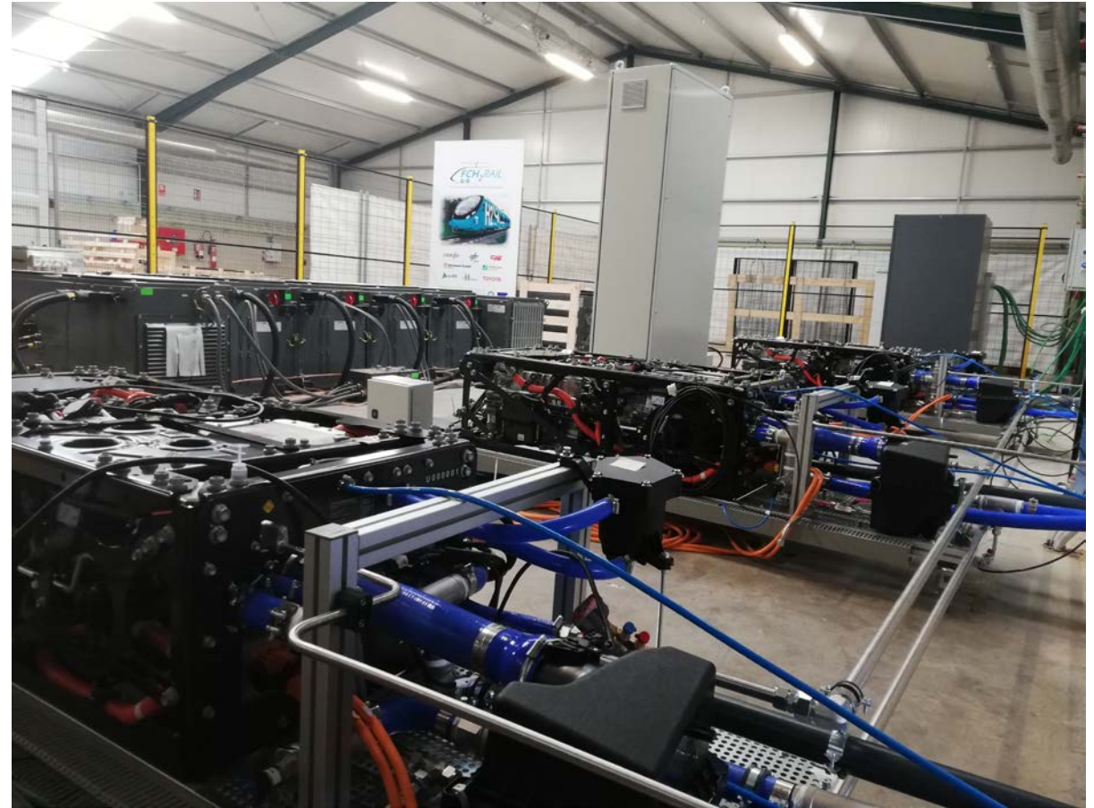
Banco de pruebas de Pilas de Combustible de Toyota en el CNH2
