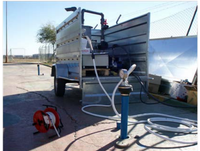
Ejecución ensayo piloto de alto vacío
