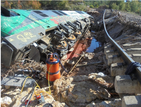
Figura 14. Locomotora y zona de vertido de combustible (Vinaixa).
