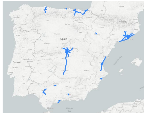
Figura 27. UMEs de los Mapas Estratégicos de Ruido de los grandes ejes ferroviarios Fase III. Tramos ferroviarios con más de 30.000 circulaciones/año en 2016.
