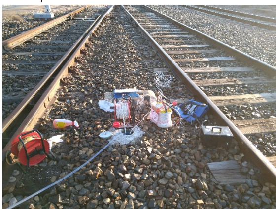
Figura 24. Ensayo de bombeo
