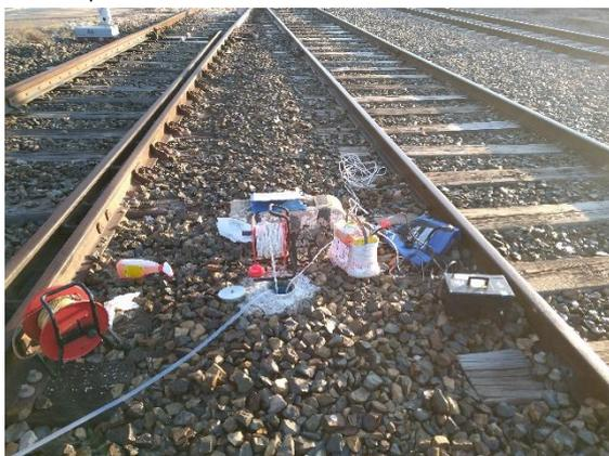
Figura 24. Ensayo de bombeo
