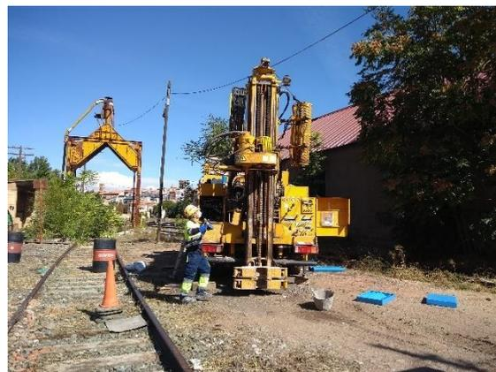
Figura 20. Perforación de sondeos (Teruel).
