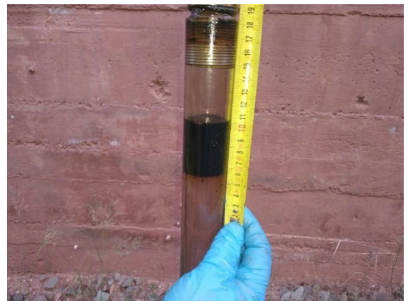
Figura 18. Detalle de skimer pasivo para hidrocarburos densos en el emplazamiento de Teruel.
