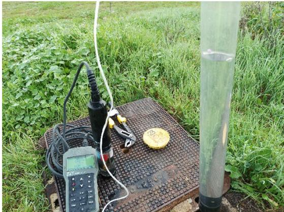
Figura 19. Medición de niveles y toma de muestra de agua subterránea con bailer. Zafra.
