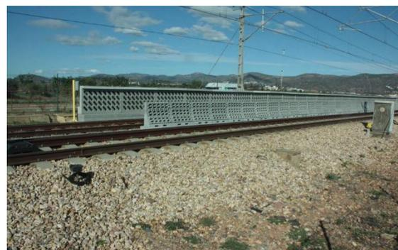
Figura 23. Ensayo de mini y microbarreras acústicas en la red ferroviaria
