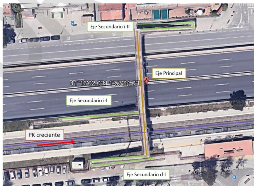
Ejemplo 5. Indicaciones de ejes principal y secundarios en paso superior de tráfico rodado.
