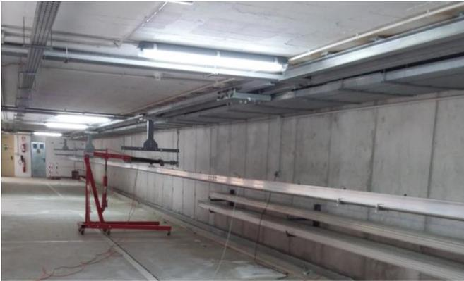
El objetivo del BECC es disponer de un banco de pruebas que permita realizar ensayos para estudiar el comportamiento mecánico de un sistema de catenaria rígida con una configuración determinada de soportes, perfiles y separación en vanos de distinta longitud, permitiendo reproducir y mejorar el comportamiento de las instalaciones existentes con este tipo de catenaria.
