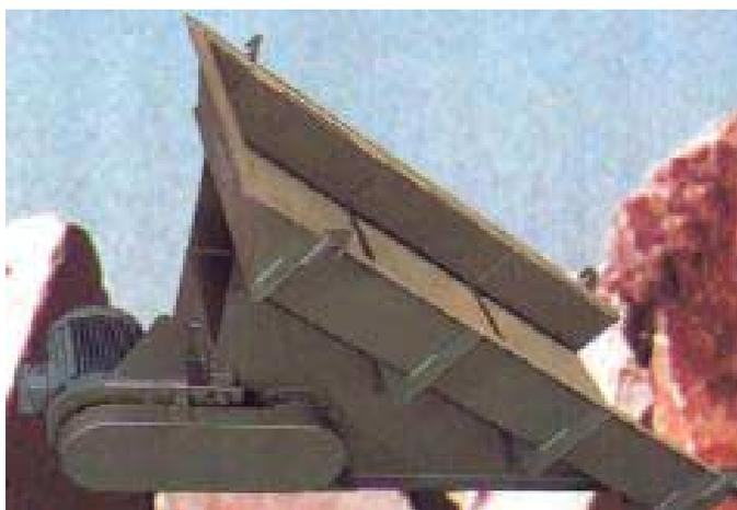
Fig. 4.1.2.2.b Alimentador vibrante.
