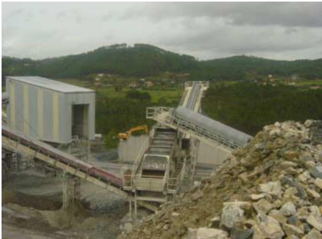
Fig. 4.1.6 Zona de cintas de transporte y silos de almacenamiento en una planta de machaqueo y clasificación.
