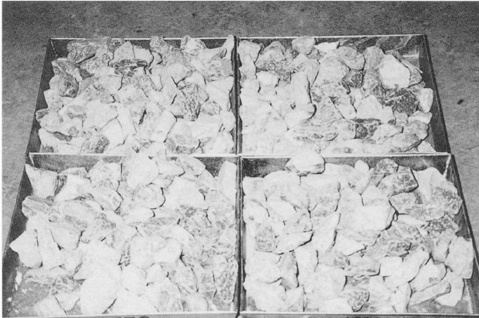
Foto 5.1. Muestra de ensayo colocada en 4 bandejas.
