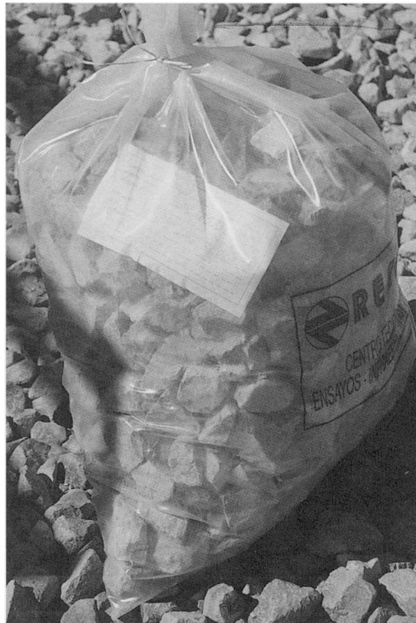
Foto 2.6.2.1.c. Muestreo en acopio. Etiquetado y cierre de saco con cinta en una muestra unitaria.
