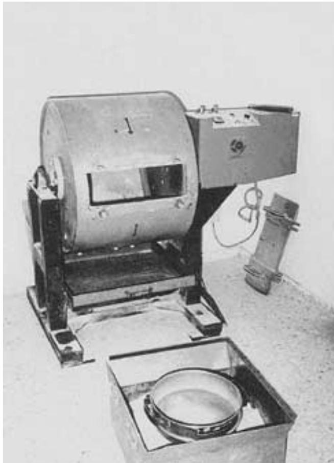
Foto 5.8.4.1.a. Máquina para el ensayo de resistencia a la fragmentación “Los Ángeles”.
