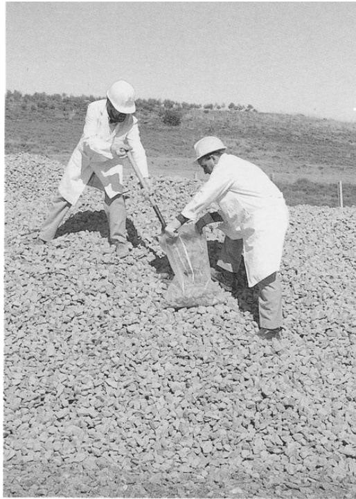
Foto 2.6.2.1.d. Muestreo en acopio con pala cuadrada cuando no existe pala mecánica.
