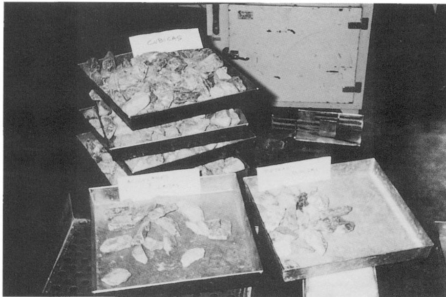
Foto 5.4.5.a. Clasificación de piedras en el ensayo de elementos aciculares y lajas.
