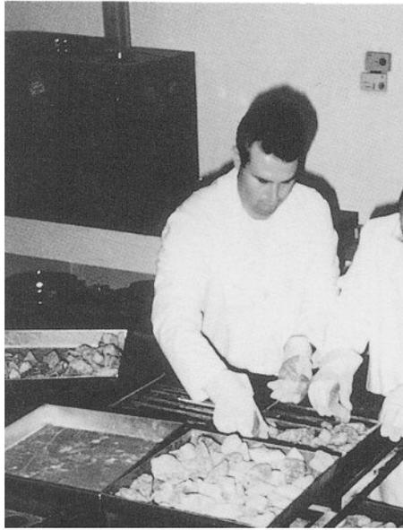
Foto 5.3.5. Paso manual de la muestra por el tamiz de barras de 25 mm.
