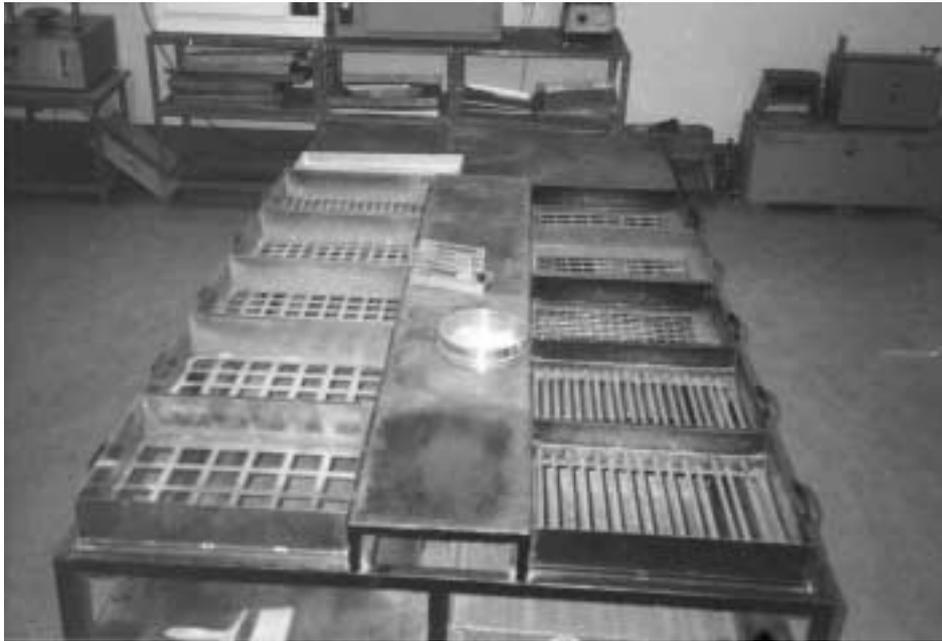
Foto 5.6.4.2.b. Tamices de ensayo sobre el bastidor metálico.
