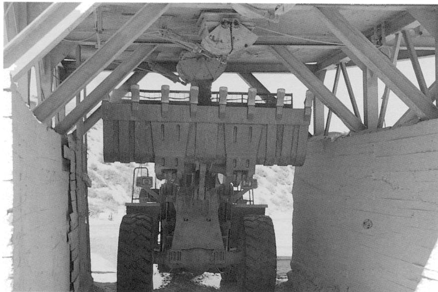
Foto 2.6.2.2. Muestreo en tolva. Recogida de balasto con pala mecánica por la boca de salida.
