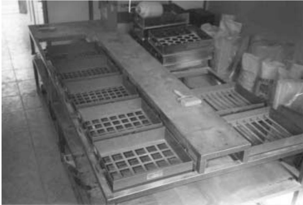
Foto 5.6.4.1.b. En el lado izquierdo de la mesa de ensayos, los tamices de luces cuadradas para el ensayo granulométrico.
