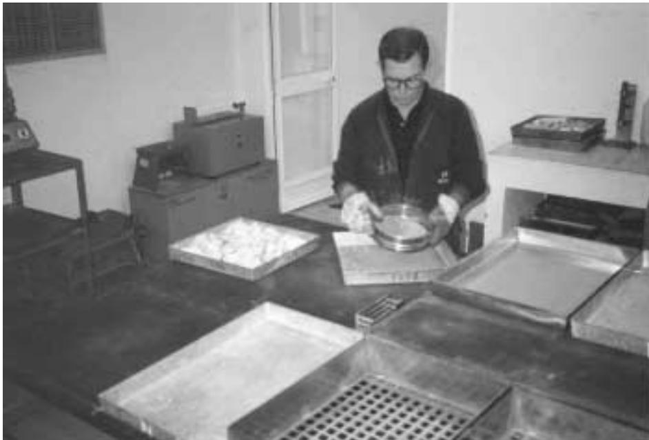
Foto 5.7.2.. Tamizado del material retenido de fondo del ensayo granulométrico, para el ensayo de limpieza de balasto.
