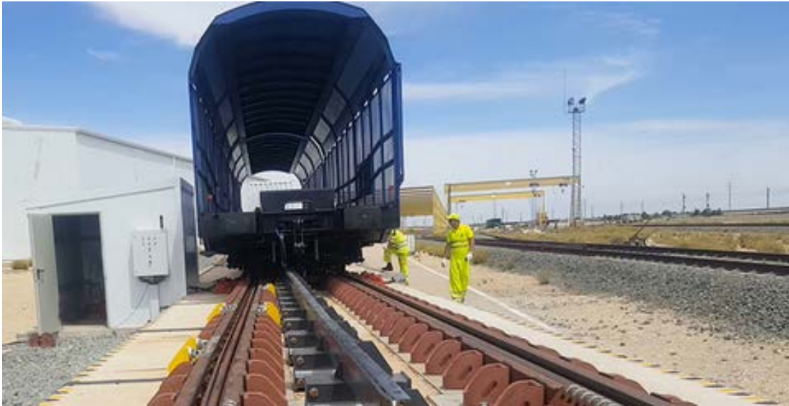
Ilustración 4: Cambiador de ancho variable de mercancías en La Gineta (Albacete)
