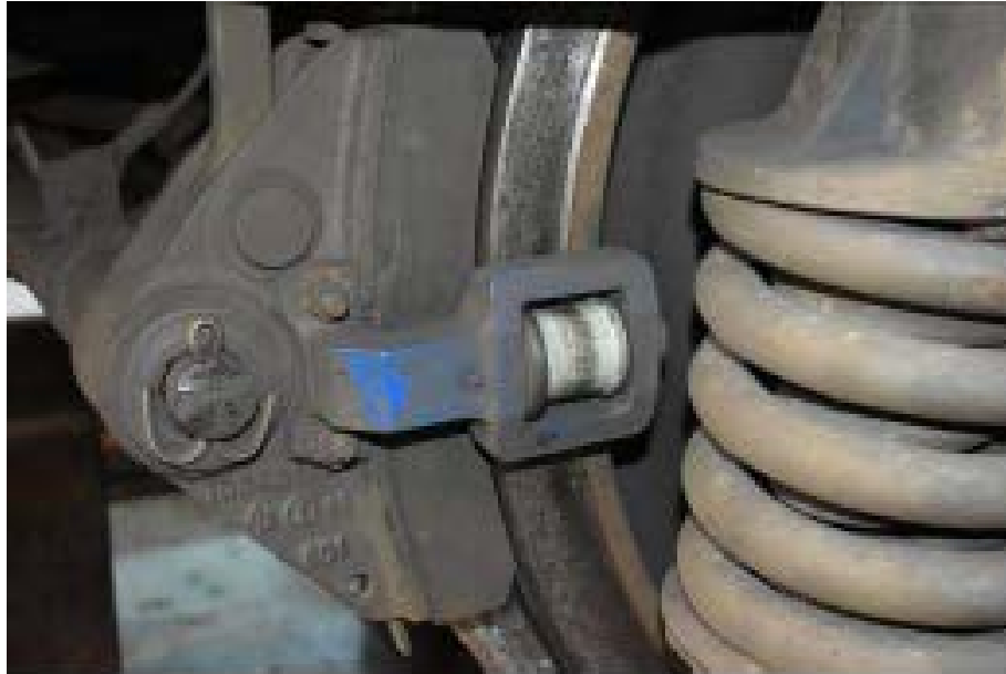
Ilustración 3: Elemento incorporado al soporte de la ZAPATA que garantiza el seguimiento de la zapata a la posición variable de la rueda
