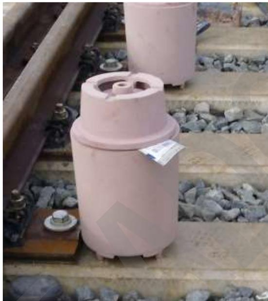
Figura 11. Ejemplo de Crisol de un solo uso.
