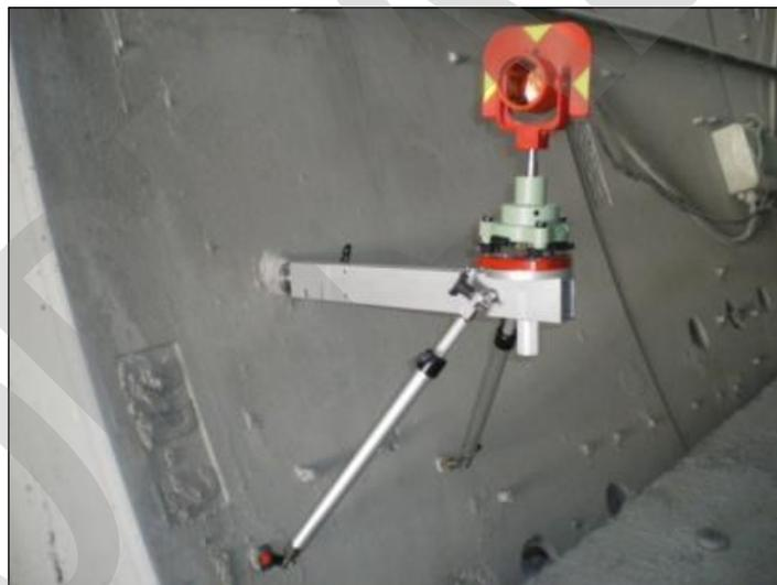
Imagen 3. Detalle de hito en hastial de túnel.
