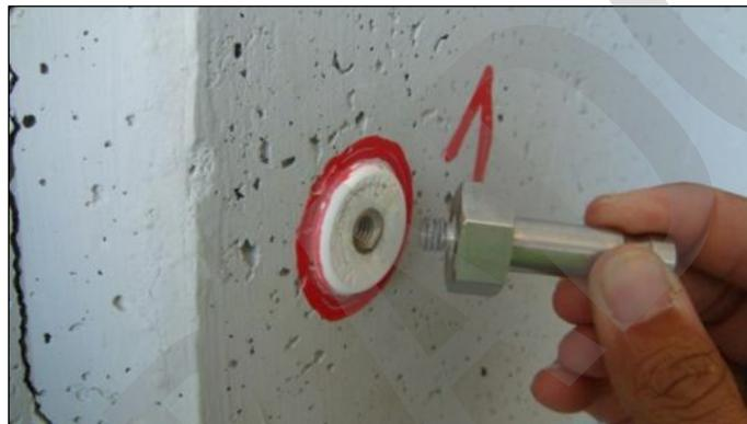
Imagen 10. Roscado de bulón sobre paramento vertical.
