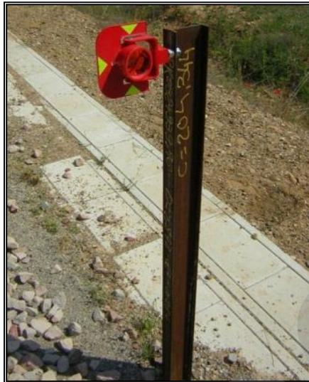
Imagen 8. Perfil metálico con punto de marcaje.
