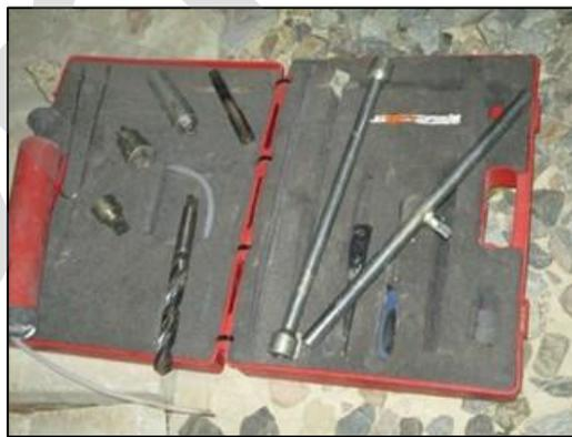
Imagen 22.-Herramientas necesarias para la reparación de espigas o vainas.
