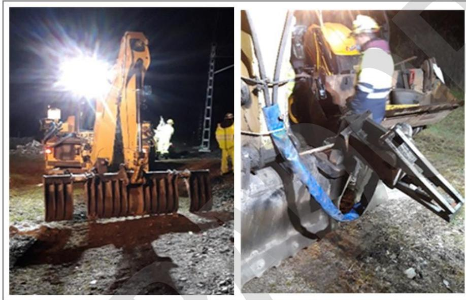
Imagen 4.- Retroexcavadora y sus componentes (pinza y escudo).
