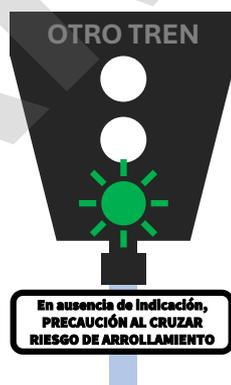
Ilustración 7. Aspecto del estado "Vaciado del cruce entre andenes".
