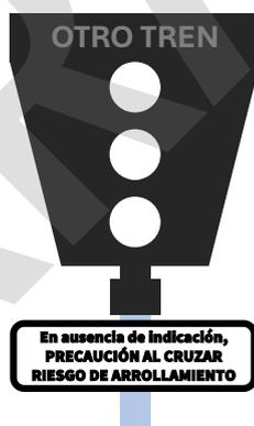
Ilustración 11. Aspecto del estado "Instalación averiada".
