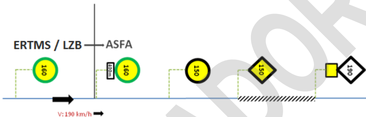
Figura 50. Señalización de anuncio de LTV con preanuncio impuesta detrás del punto de transición de ERTMS o LZB a ASFA. No existe cambio significativo de velocidad.
