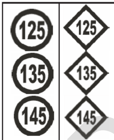
Figura 4. Ejemplo de conjunto de tres señales fijas independientes, en función del tipo de tren al que aplica.
