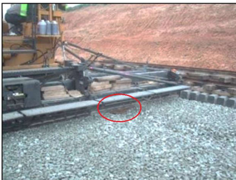
Imagen 20. Ejemplo de útil para huella acoplado en extendedora.
