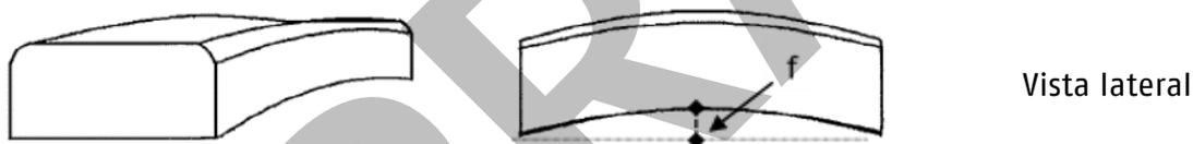
Fig. 3 Esquema aclaratorio de la flecha de cara
